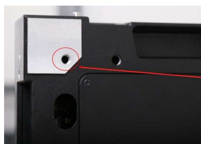
Trou permettant de fixer le tableau par l'avant sur un mur ou par l'arrière sur une structure
